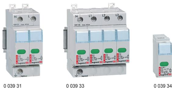
УЗИП Класс 2 предназначены для защиты сети от коммутационных помех или как вторая ступень защиты при ударе молнии. Нормируется импульсным током с формой волны 8 / 20 мкс. Состоят из основания и сменных модулей с сигнальным индикатором:
